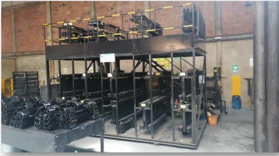
*Figura 8 Estructura de almacenamiento piezas finalizadas*
