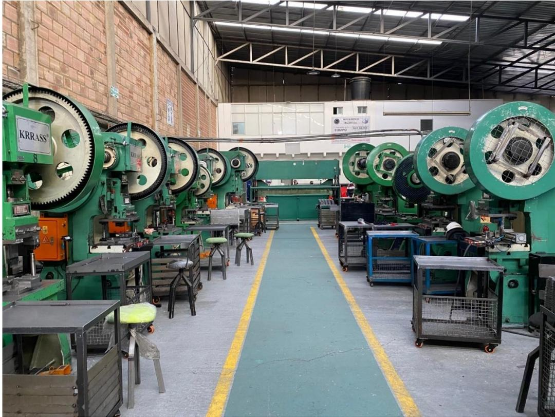
*Figura 1 Línea completa de producción con troquelaría*
