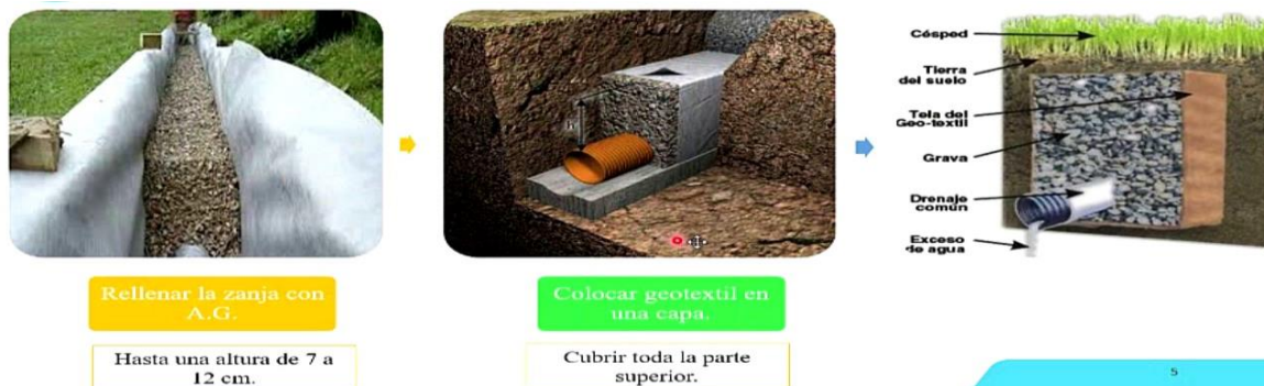
Figura 19. Sistema de drenaje francés.
