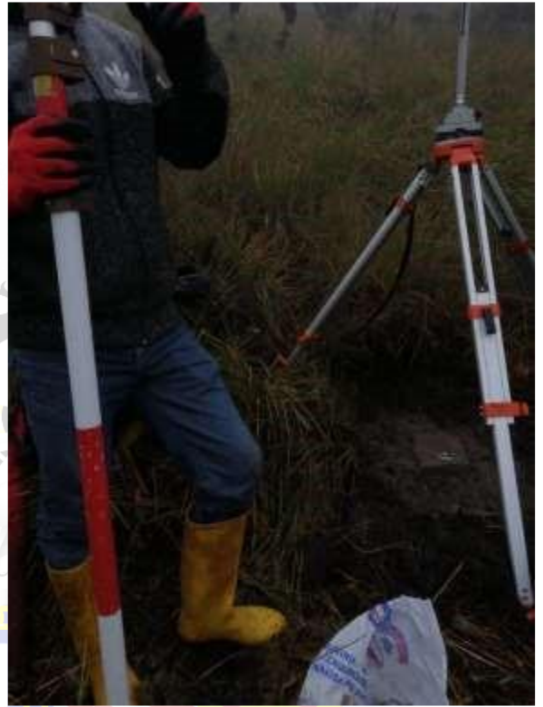
Ilustración 15. Base y Rover inicio de levantamiento. Fuente: Propia
