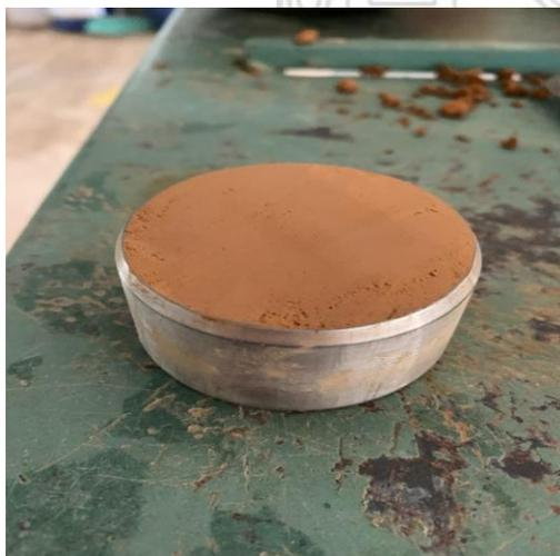
Ilustración 2. Muestra inalterada
