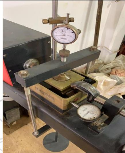
**Ilustración 6. Ensayo de corte en proceso**
