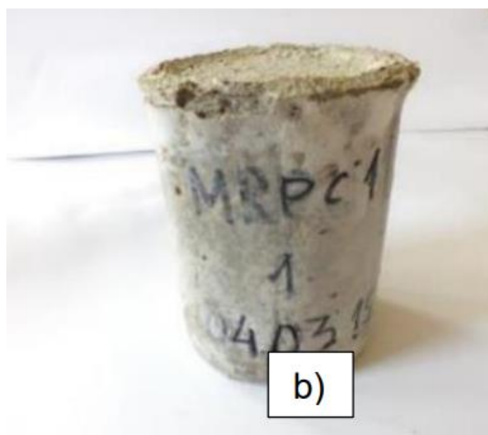
Ilustración 8. Formación de yeso en concreto expuesto a \text{CaSO}_4 Nota: Adaptado por Cubillos en [48].
