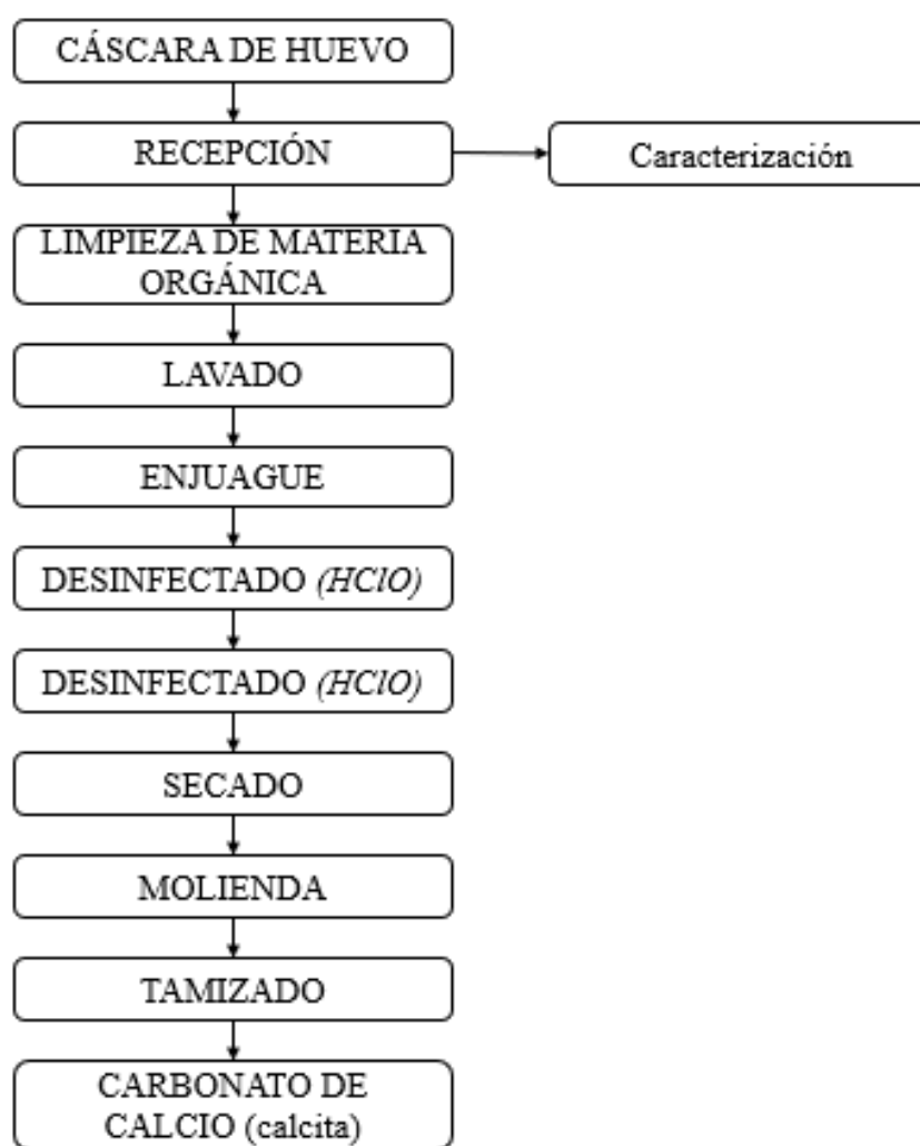
Ilustración 12. Diagrama de flujo para la obtención de calcita
