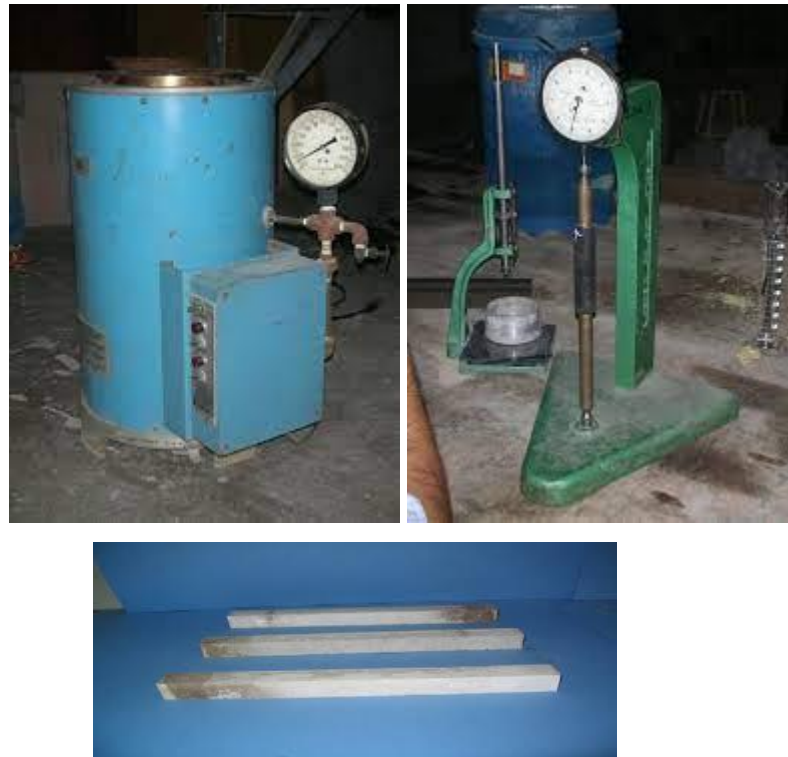
Ilustración 2. Determinación de la expansión de cemento portland en autoclave
