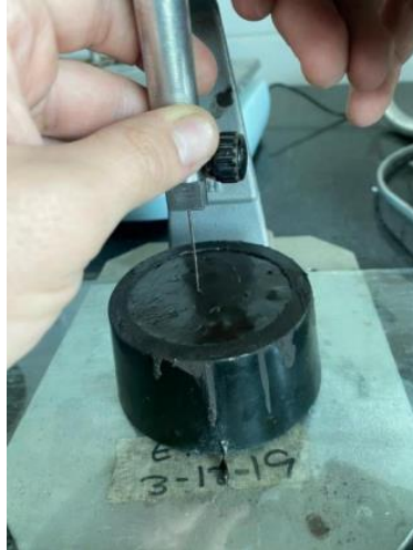
Ilustración 3. Ensayo de tiempo de fraguado con la Aguja de Vicat en [40].
