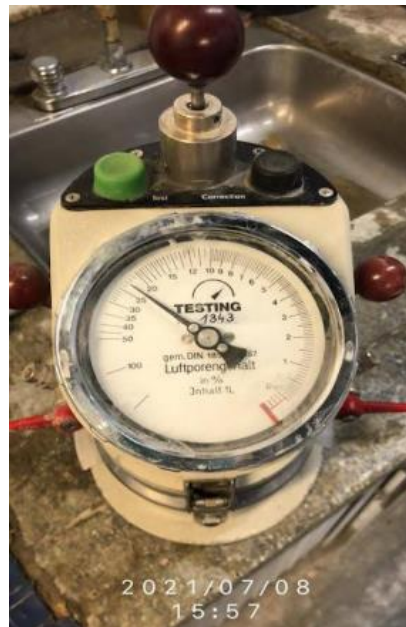
Ilustración 4. Medidor de aire ocluido en morteros Fuente: Rodríguez & Díaz en [41].
