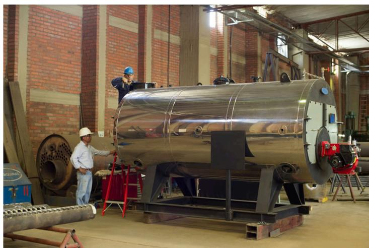
Fig. 4 Caldera pirotubular horizontal de la empresa Colmaquinas
