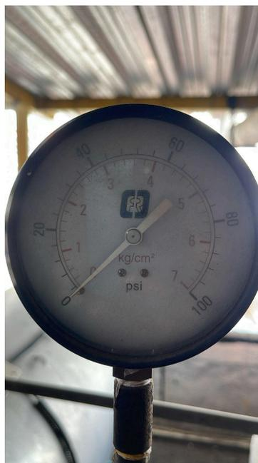
Fig. 18 Manómetro indicador de presión de la caldera
