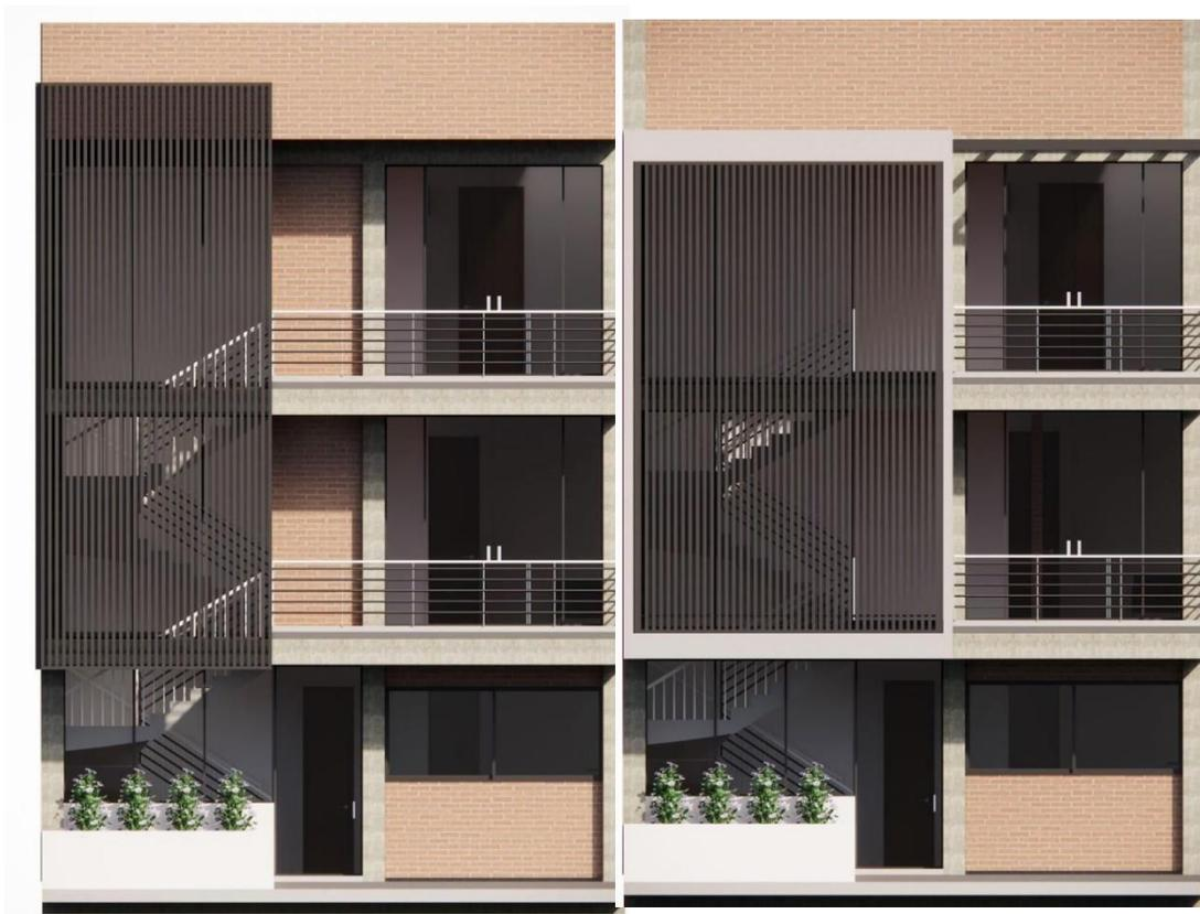
*Ilustración 7-8 fachadas con manejo de persianas para el manejo de luz natural. Fuente elaboración propia*
