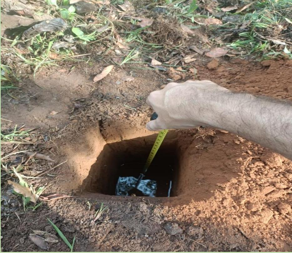
Se llevo a cabo la prueba de infiltracion o percolacion del agua en el suelo en tres calicatas de la plantacion caracoli para determinar la capacidad de infiltracion y poder diseñar el campo de infiltracion requerido para el pozo septico
