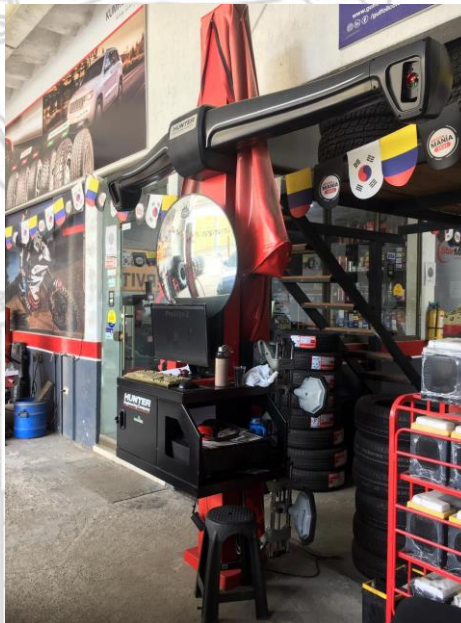
Imagen 5. Alineadora VASCO, fuente: autor de este trabajo
