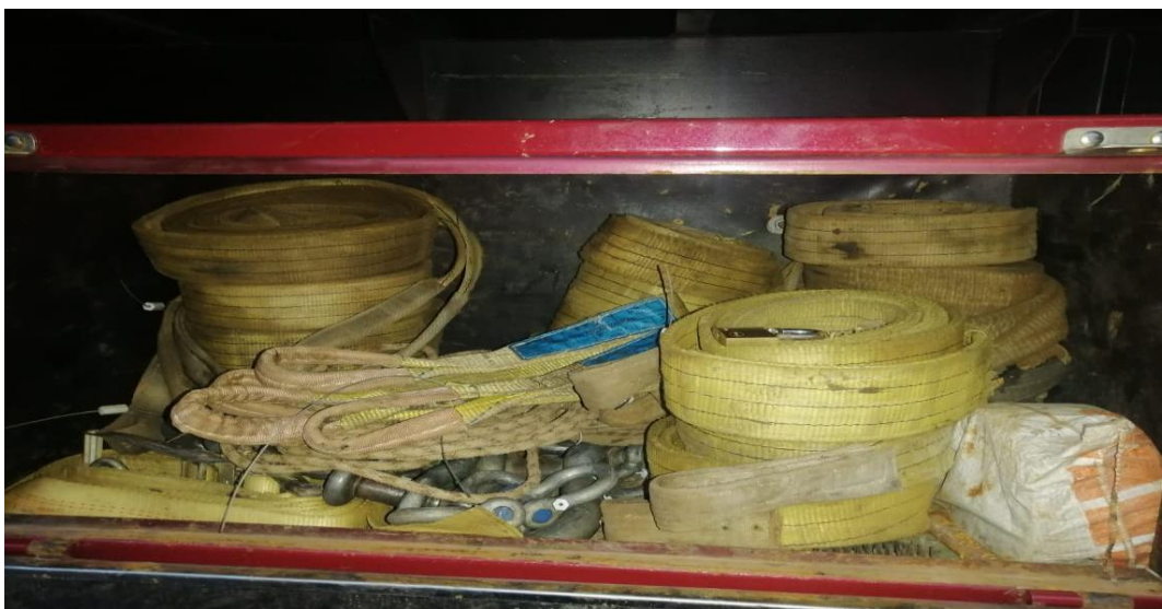
Figura 8, verificación de precintos y certificación de eslingas y grilletes. Fuente: Propia
