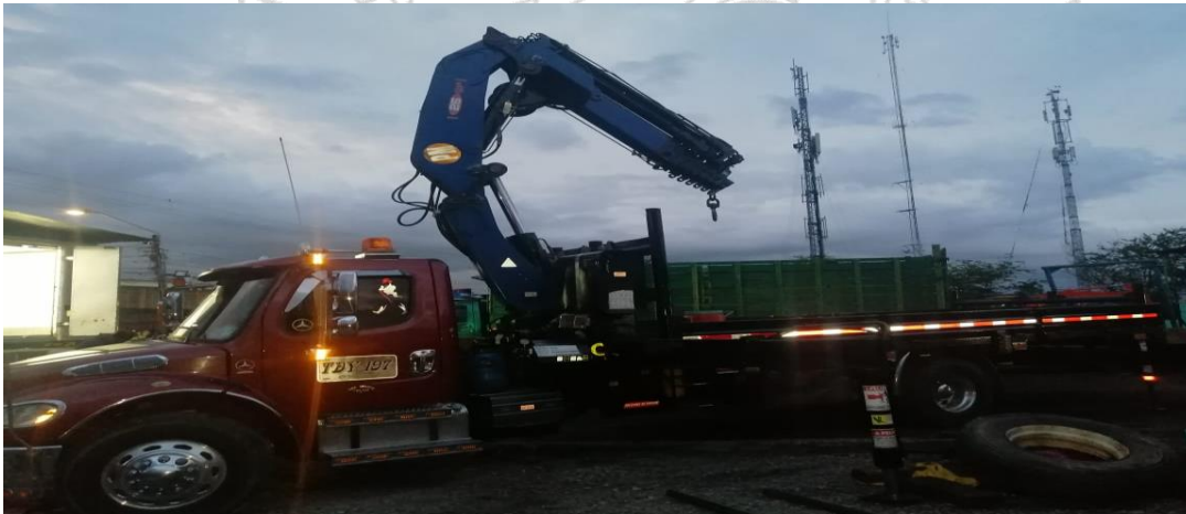
Figura 7, se hace una salida a campo con el fin de Inspeccionar un camión grúa con capacidad de 10 a 12 Toneladas.
