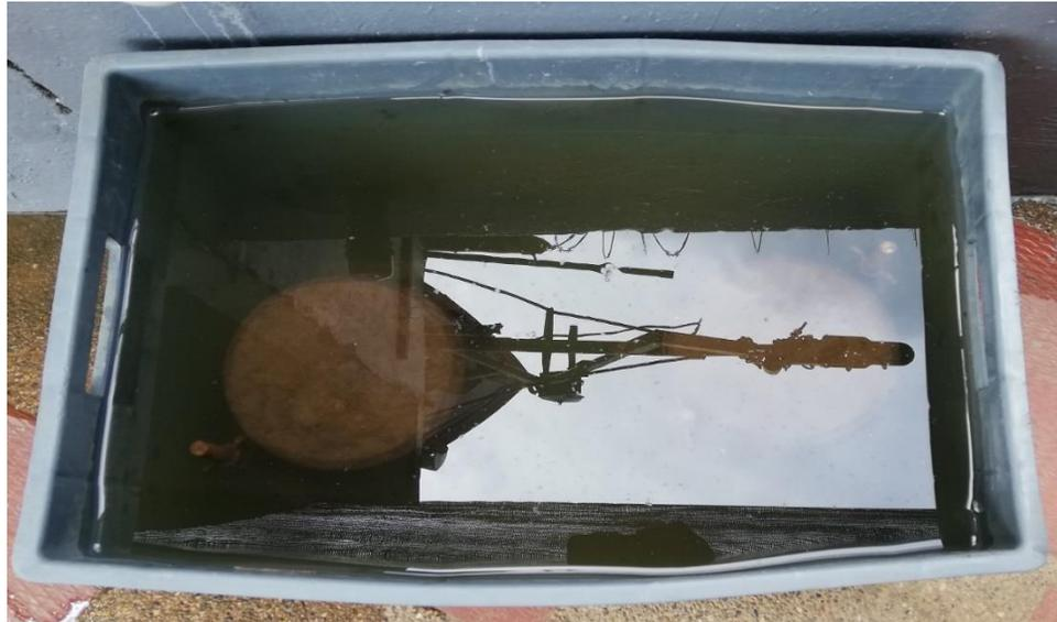
*Ilustración 14 CBR sumergidos en agua durante 24 horas*
