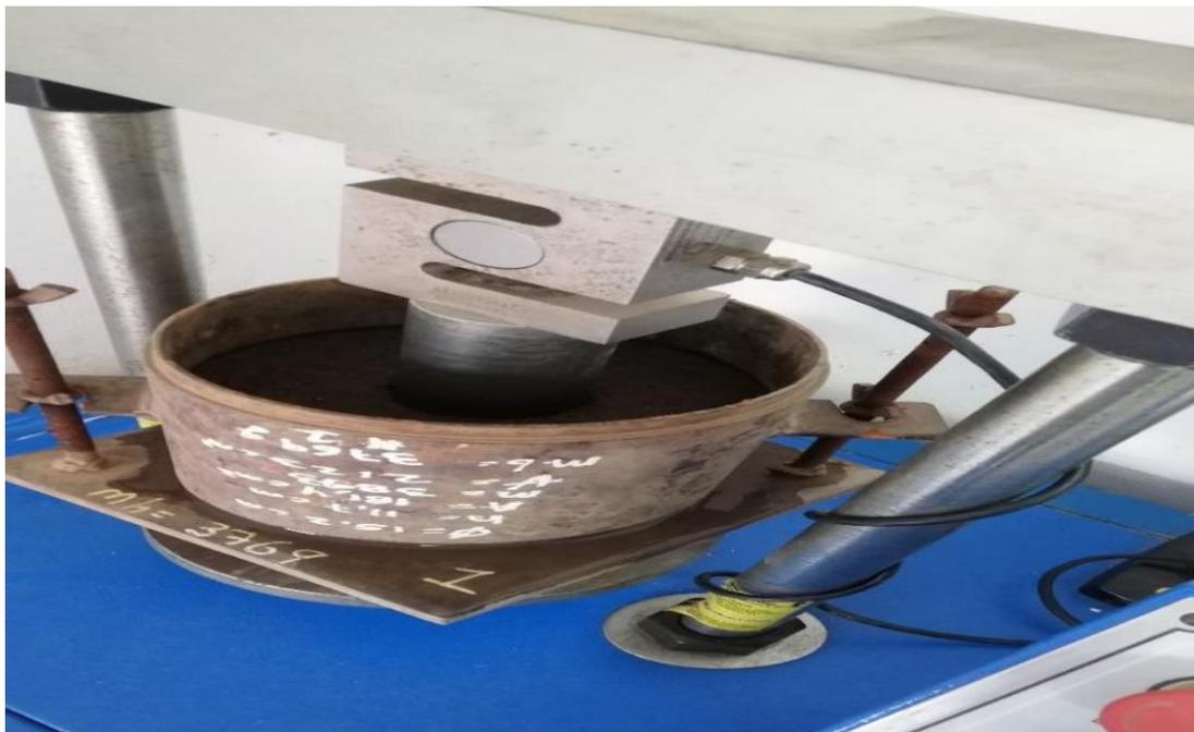
*Ilustración 15 Falla del CBR después de estar sumergido durante 24 horas*
