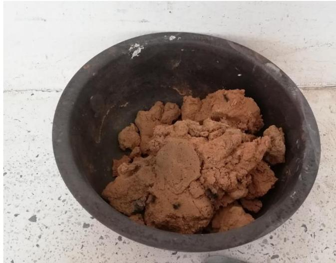
*Ilustración 18 Muestra de suelo lista para ser secada y determinar su humedad*
