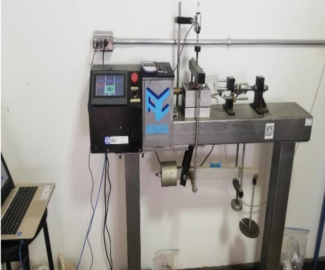
*Ilustración 16 Equipo de corte para realizar el ensayo de corte directo*
