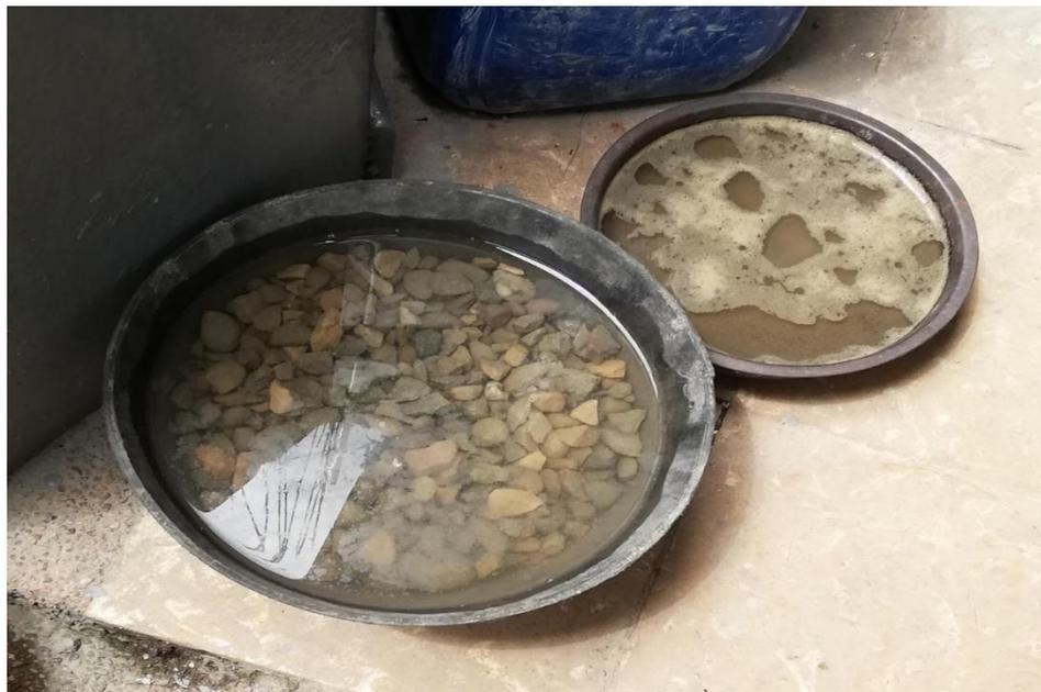
Ilustración 11 Absorción y peso específico de los agregados 2
