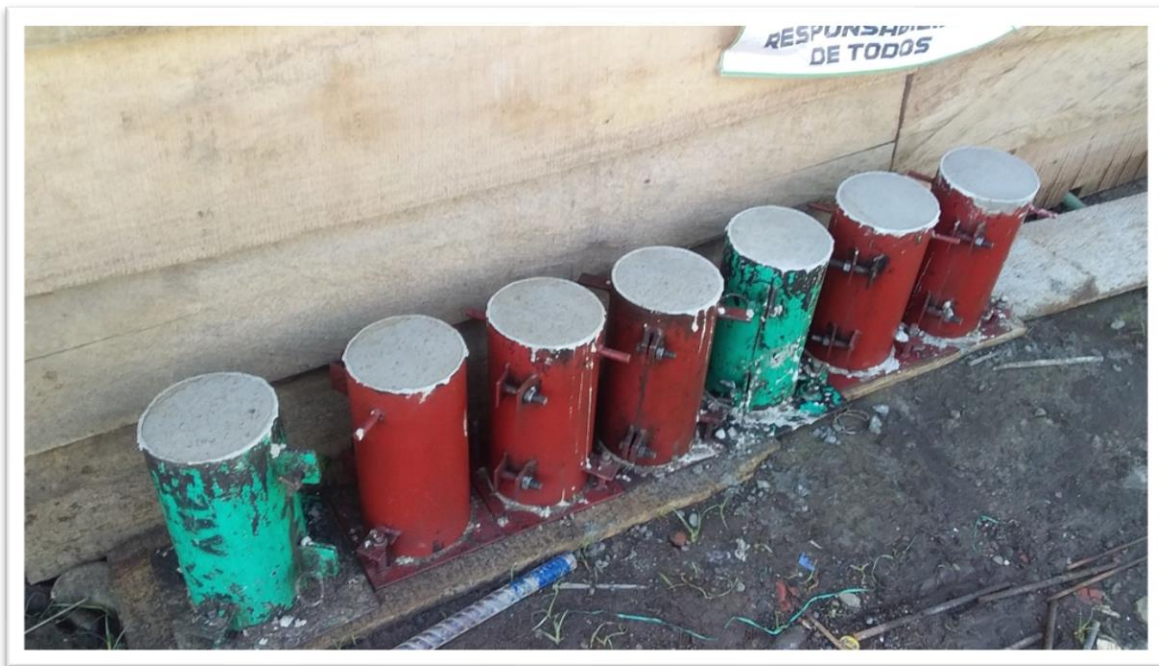
Imagen 1: prueba de resistencia a compresión del concreto. Fuente: propia.
