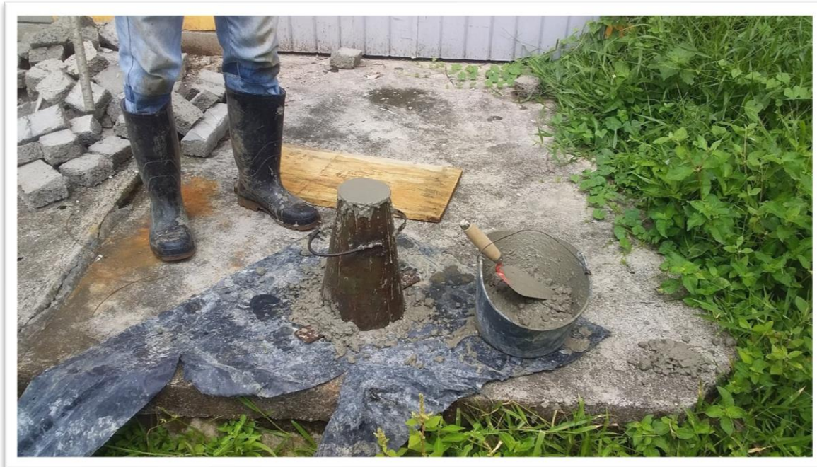
Imagen 2: prueba de consistencia del concreto. Fuente: propia.
