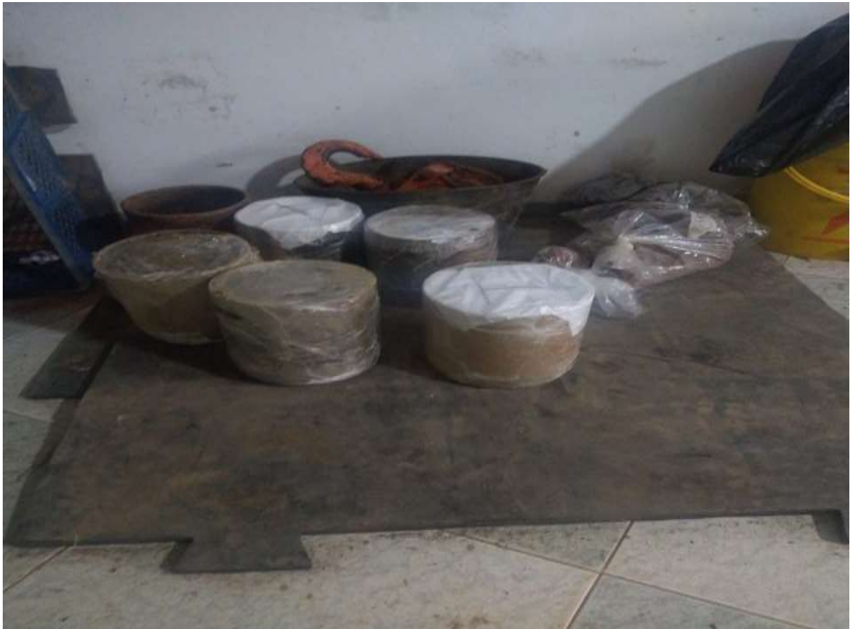
Registró fotográfico 2. Muestras de suelo proyecto vial para la aplicación de ensayo de CBR.
