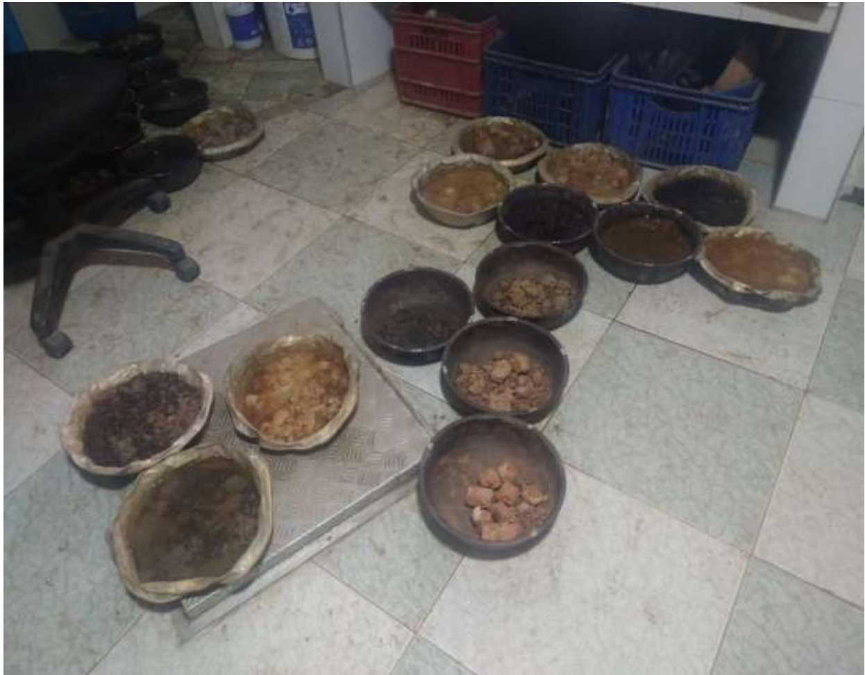
Registro fotográfico 3.. Muestras de estrato de suelo obtenidas a 0.5 y 0.8mt para la evaluación de capacidad portante para casas de interés social en el municipio fuente de oro.
