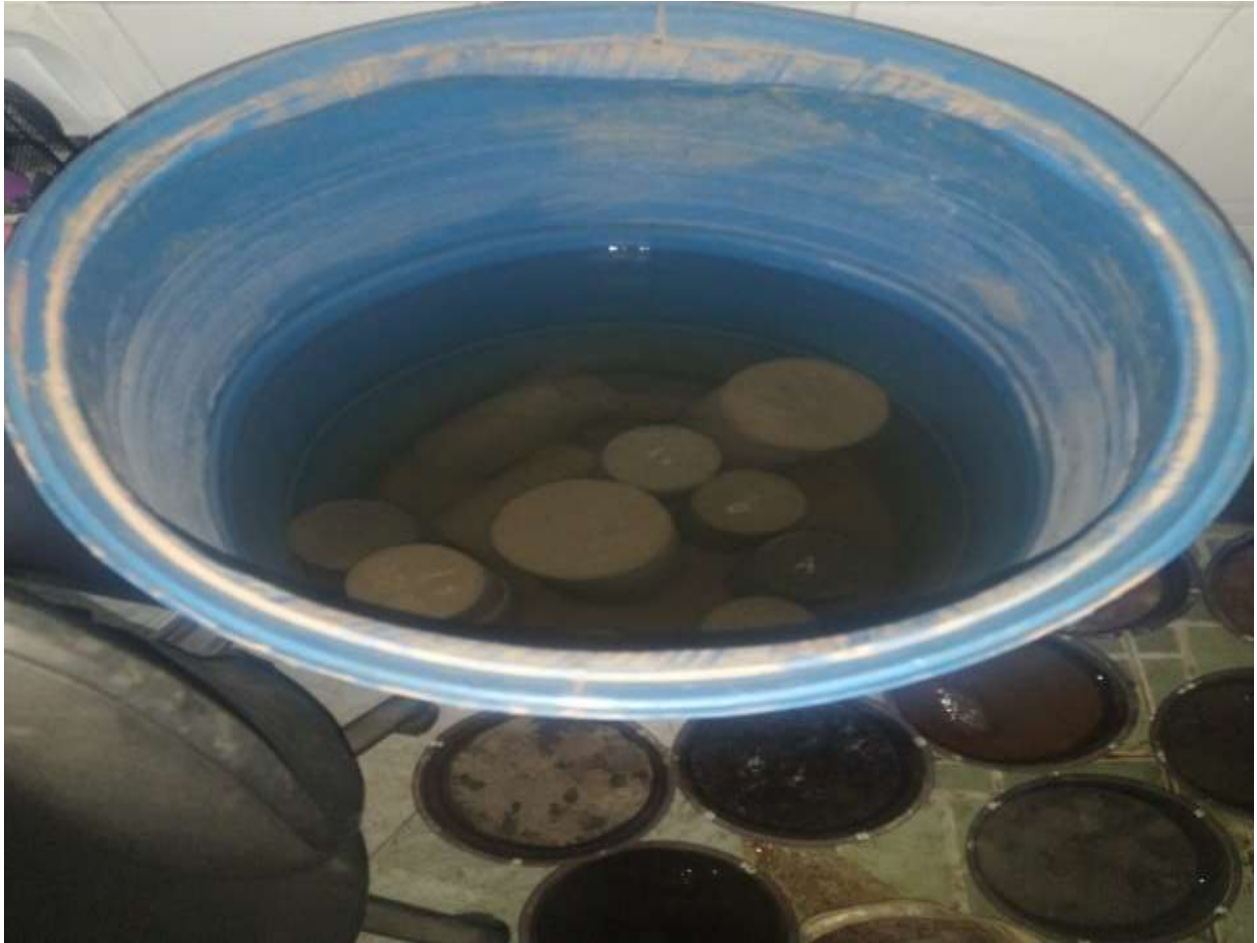
Registro fotográfico 1. Muestras de elemento estructural (columna), sumergidos en agua para la aplicación del ensayo fallo a compresión a los 7, 14 y 28 días.
