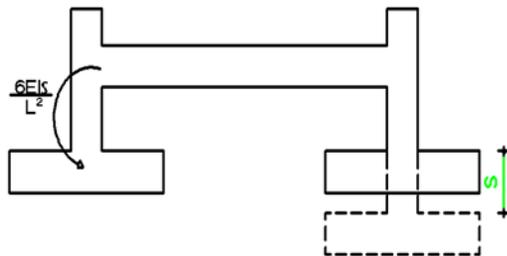
(Momento inducido en un extremo de la viga de fundación por el asentamiento diferencial)
