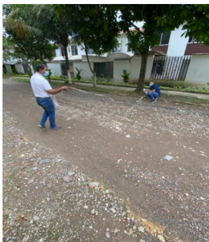
Ilustración 6 medición Ancho Calzada Barrio Barlovento
