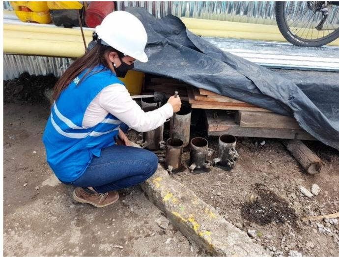
*Ilustración 10 Toma de muestra del concreto*
