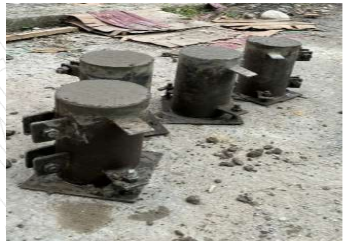
Ilustración 21 Realización de pruebas de asentamiento y toma de cilindros de concreto.
