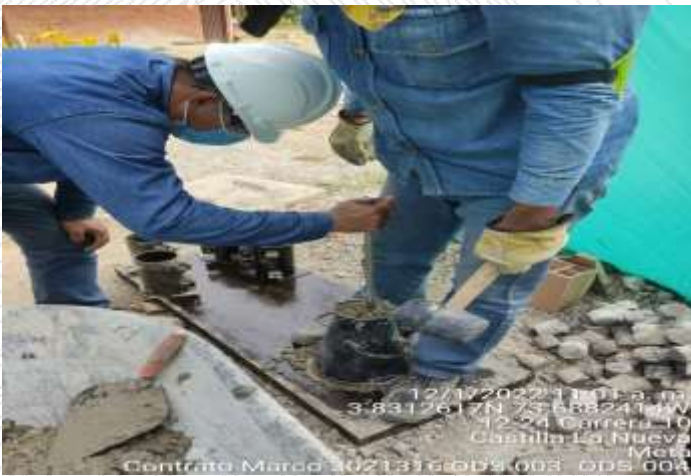
Ilustración 21 Realización de pruebas de asentamiento y toma de cilindros de concreto.
