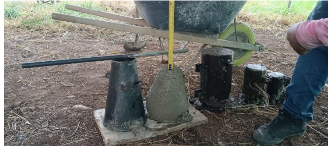
Ilustración 17 Prueba asentamiento concreto
