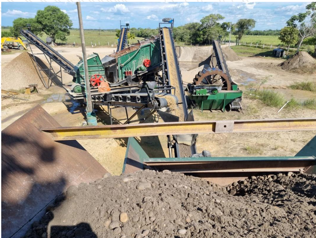
Anexo 8: Foto Proceso de material; trituración
