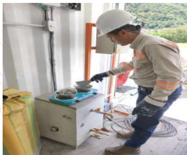
Realización porcentaje de humedad del agregado
