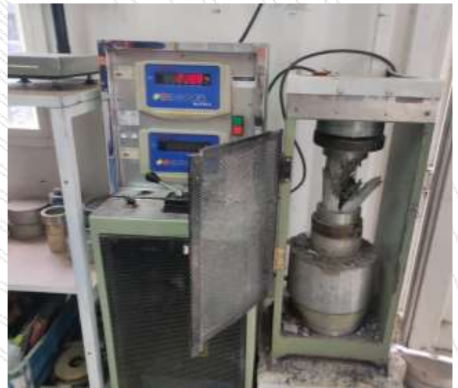
Tipo de falla de Cilindros
