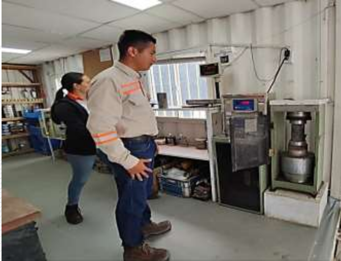
Falla Muestras de Concreto
